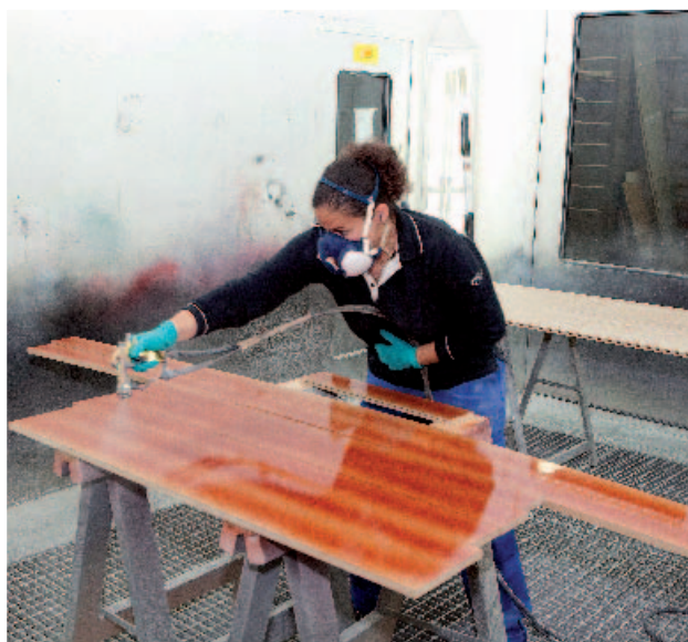
↑ Vernis. L'atelier d'application de vernis est équipé d'une cabine à flux vertical, ainsi que de deux sas de désolvatation, eux-mêmes raccordés à une centrale d'aspiration.
